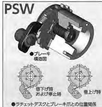
30年の実績を持つ当社独自の馬蹄形スプリングを使用。巻上げ時にブレーキ爪がラチェットデスクから離れる構造の為、ブレーキ爪の音が殆どなくなり無騒音ウインチが実現しました。また他社の様なフリーホイール形式やローラークラッチ形式の振動等によるスリップもない安全な機構です。劇場・病院等騒音が規制される場所でのご使用に最適です。オプション(透明ブレーキカバー)ブレーキ機構部の点検を容易に出来る透明のブレーキカバーもご用意しています。
