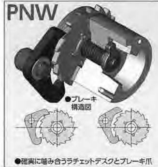
一方の爪がラチェットデスクを離れると、他方の爪が噛み合うダブルブレーキ爪を採用。そのため如何なる状態の下でもブレーキ爪が外れることがないので安心です。スプリングを使用していないので、音も静かで、噛み合い部の摩擦も極めて少なく耐久性の高いブレーキとなっています。
