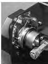
メカニカルブレーキは実績と信頼性の無騒音PSW型を採用の上、軽荷重ブレーキ機構を追加、更にはブレーキ部の点検がし易い様に透明ブレーキカバーを採用、二重三重の安全策が取られています。
